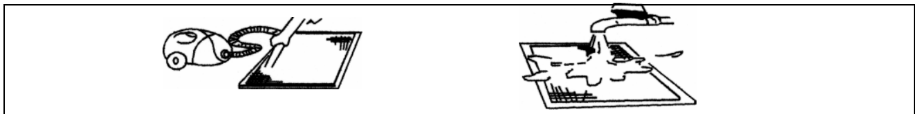
FIGURA 6: Limpieza del Filtro de Aire
